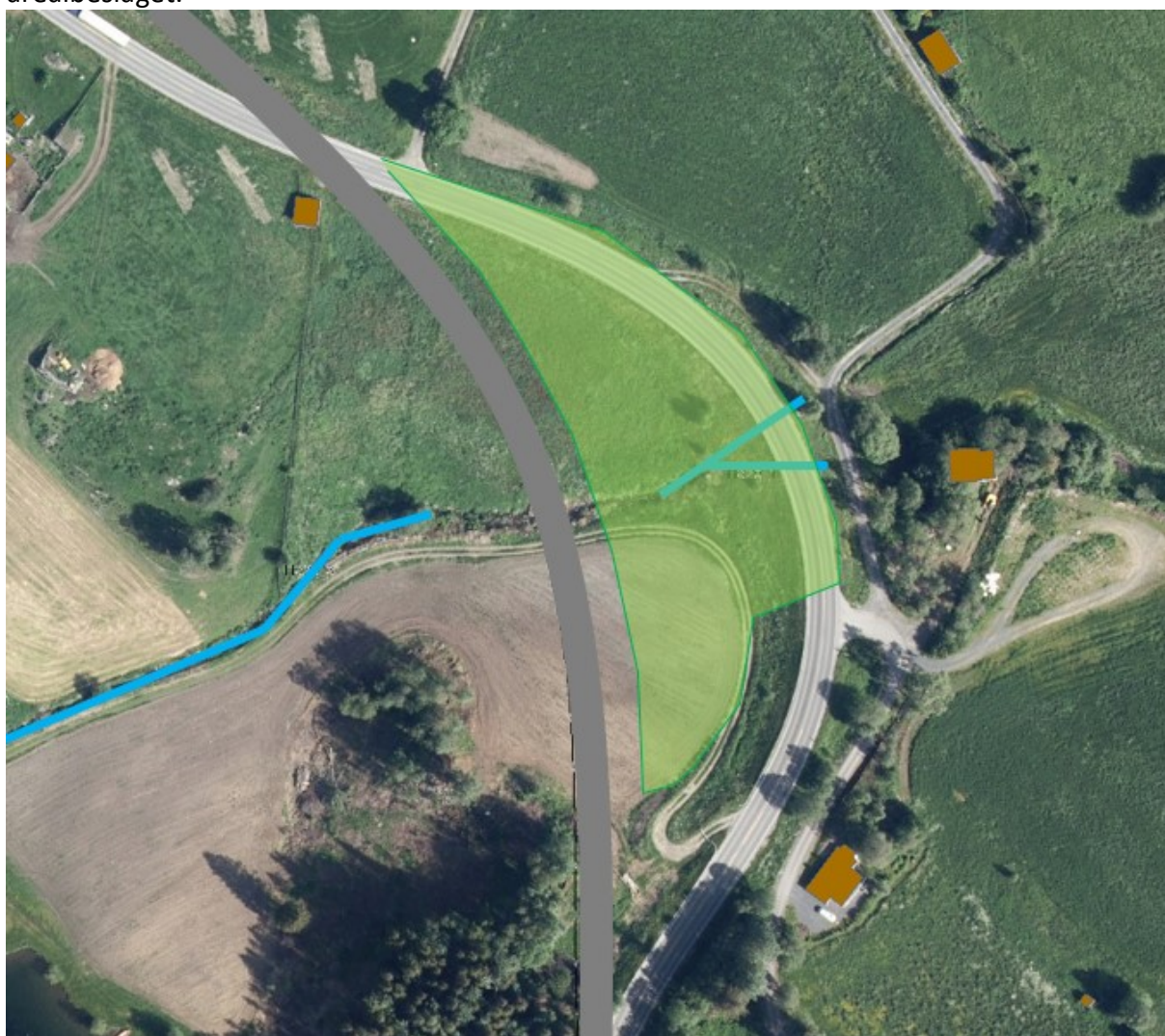
Figur 41: Reiensvingen er den kurven i planområdet som i størst grad vil få en ny utforming. Deler av eksisterende E16 vil her bli gravd vekk og innlemmet i tilgrensende dyrka mark, i tråd med krav i planbestemmelsene. Det legges opp til fjerne eksisterende stikkrenner der E16 fjernes slik at de to bekkeløpene her blir åpne. Siden bekkene ligger i et fareområde for flomras, vil det i tråd med krav i bestemmelsene bli vurdert tiltak oppstrøms og nedstrøms E16 for å forebygge oppstuvning, erosjon, suspensjon og skred. Det skal vektlegges åpne løsninger. Sprengstein brukt til plastring av bekker må være vasket slik at de er fri for kjemikalier og sprengstoffrester og ikke inneholde steinnåler.
